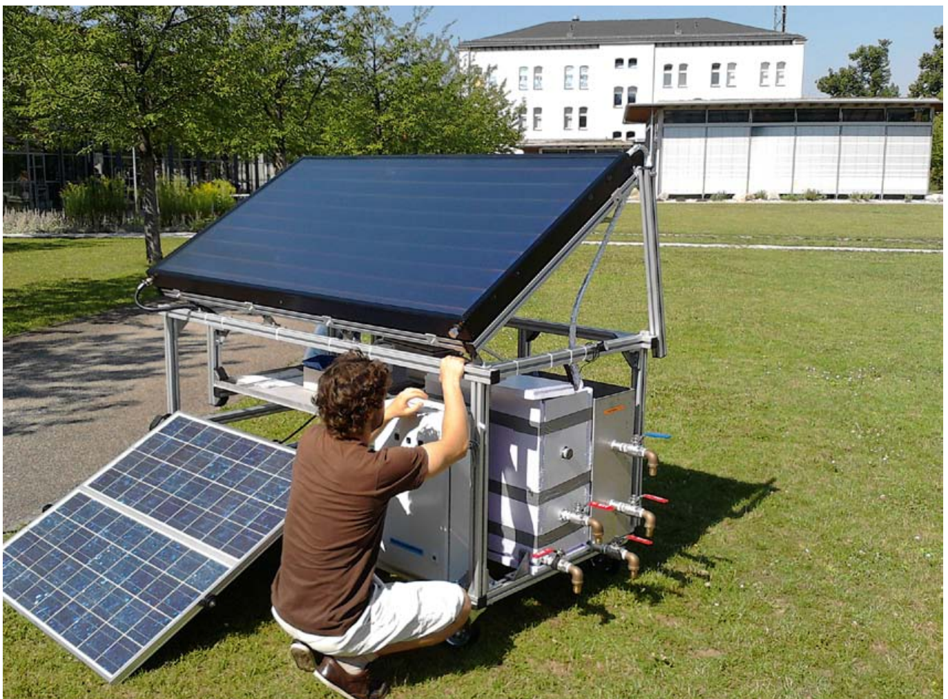
Abbildung 2: Energieautarke Membrandestillation zur Produktion von Trinkwasser aus salzhaltigem Wasser
