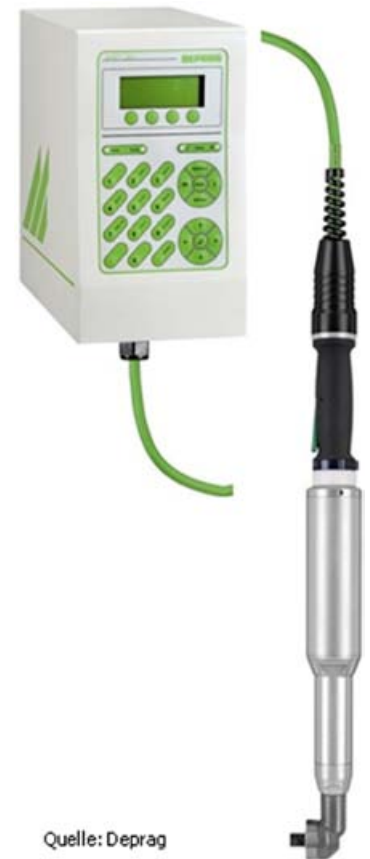
Abbildung 5: Hochwertiges industrielles Schraubsystem mit permanentem Synchronmotor
