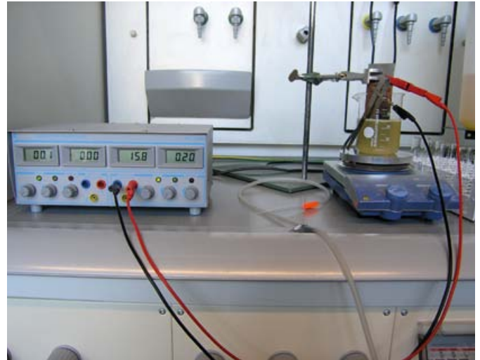
Abbildung 3: Versuchsstand im Labormaßstab zur Rückgewinnung von Phosphor aus Abwasser durch Einsatz einer Magnesiumelektrode
