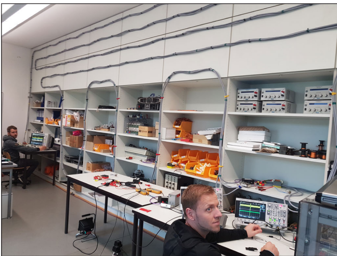
Abbildung 4. Mäanderförmig verlegte Übertragungstrecke zur Untersuchung des Kommunikationsverhaltens bei gleichzeitiger Energieübertragung mit Kabelstrecken von über 300 m Länge
