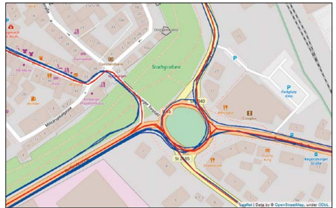
Abbildung 5: Beispiel für Map-Matching (blau: aufgenommene GPS-Koordinaten, rot: den befahrenen Straßen zugeordnete GPS-Koordinaten)
