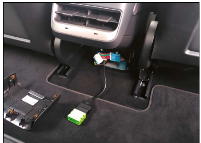
Abbildung 3: OBD-Adapter zum Abgriff von Daten aus dem CAN-Bus des Fahrzeugs
