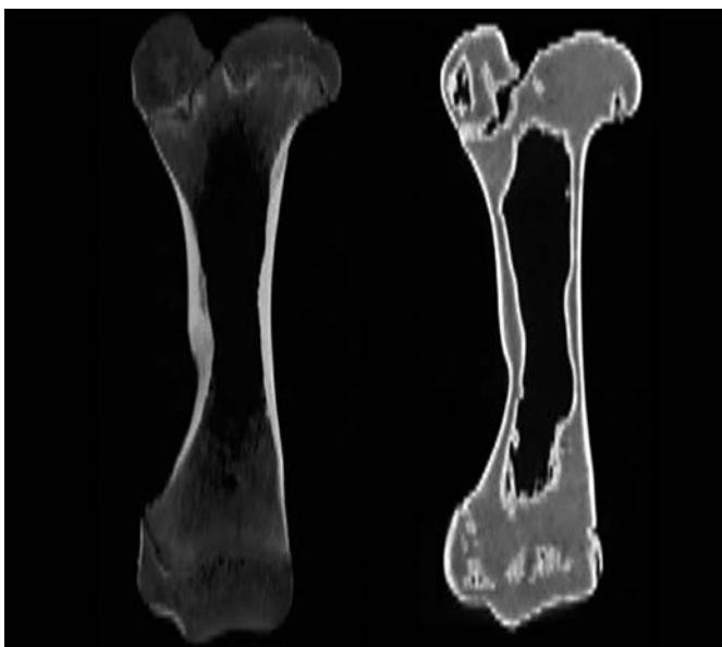
Abbildung 2: Schichtbildaufnahmen eines Femurs und des darauf basierenden Phantoms. Links: Femur eines Jungschweines. Rechts: Phantommachbildung aus ProtoPasta Magnetic Iron PLA mit einer Fülldichte von 62 %, was den mittleren Hounsfield-Werten für kortikalen Knochen entspricht.
