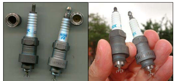
Abbildung 1: Vorkammerzündkerzen mit Platinelektroden (Vorkammer abgenommen): Senertec 5979050B11 (neu) und 44598-478B11 (alt).
