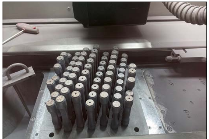
Abbildung 6: Foto von Proben auf einer Bauplatte nach dem Drucken. Die Serien von Exemplaren mit Löchern in ihren Köpfen werden in dieser Arbeit nicht behandelt.
