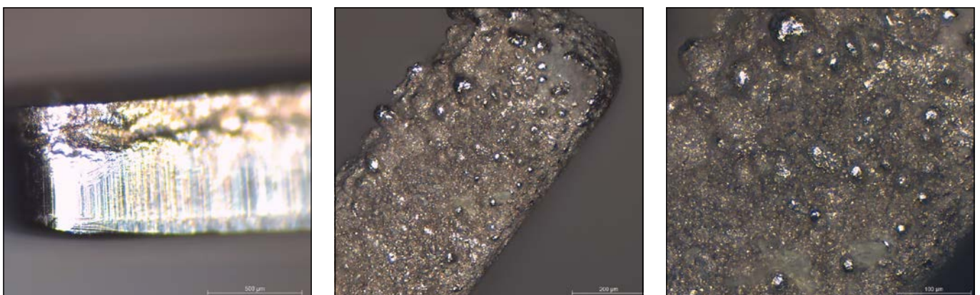
Abbildung 4: Lichtmikroskopischer Vergleich: Fabrikneue (links) und gebrauchte Platinelektrode (Mitte). Elektrode mit 65 µm bis 103 µm großen Schmelzperlen (rechts).
