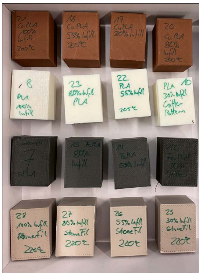
Abbildung 1: Testwürfel aus den unterschiedlichen Filamenten. Erste Reihe von oben: Testkörper aus Kupfer Filament, zweite Reihe: PLA Filament, dritte Reihe: Eisenfilament und letzte Reihe: Steinfilament.
