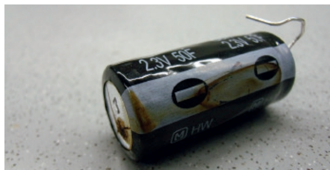
Abbildung 1: Kommerzieller Superkondensator nach einem Ausfalltest unter thermischer Überlast
