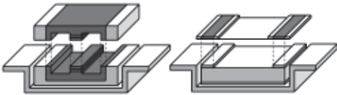
Abbildung 2: Aufbau Versorgungsschiene, links Energie-, rechts Datenübertragung
