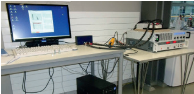
Abbildung 3: Langzeitprüfung eines neuartigen 600-V-Metallfilmkondensators im computergesteuerten Zyklentest
