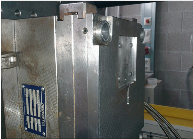
Abbildung 2: Im Versuch verwendetes Spritzgießwerkzeug ohne eingelegten Werkzeugeinsatz
