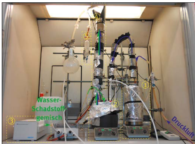
Abbildung 1: Versuchsaufbau aus (1) beheizter Kupferspirale zum Vorwärmen der Druckluft, (2) Verdampfungsgefäß mit Gemischzufuhr, (3) Dosierpumpe, (4) Adsorber-Kolonne, (5) Entnahmeeinrichtung für Abluftproben.
