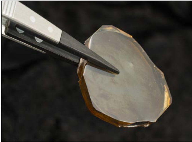
Abbildung 1: Mit dem PVT-Verfahren am Fraunhofer-Institut IISB gezüchteter Aluminiumnitrid-Kristall [7].
