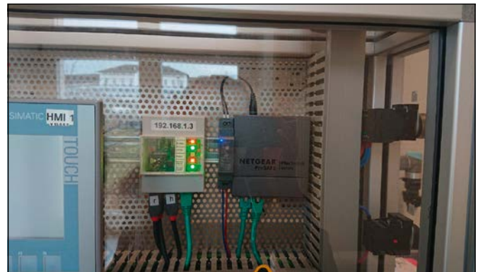
Abbildung 7: Raspberry Pi als Basis für intelligente Sensoren/Aktoren
