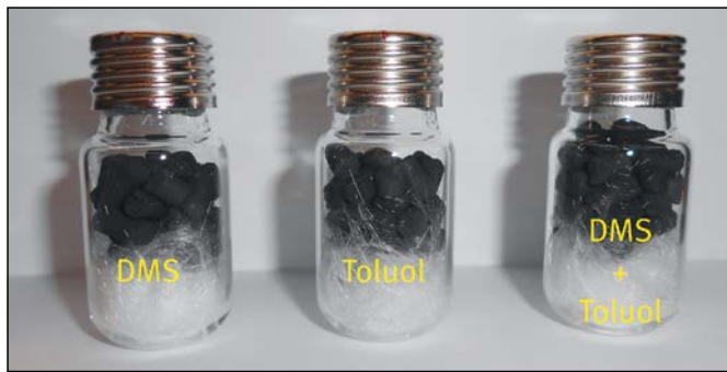
Abbildung 5: Headspace-Gläschen mit Aktivkohle und Dimethylsulfid-Toluol-Gemischen.
