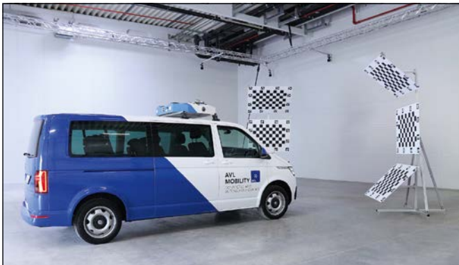
Abbildung 1: Für AUTOBUS umgebaute VW Kleinbus, ausgestattet mit Roof-Top-Box. Die Schachbrettmuster dienen der Kalibrierung der Kamerasensoren der Roof-Top-Box. (Quelle: AVL Software and Functions GmbH)
